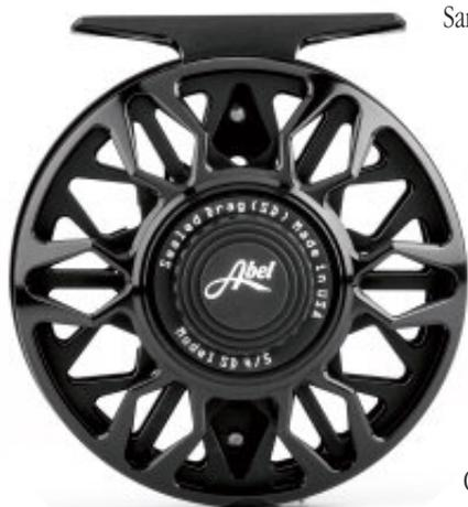
Sans aucun entretien, ce système de frein multi-disques en Rulon et Aluminium anodisé est complètement scellé dans un bain de lubrifiant. C'est le seul frein du marché entièrement étanche à la poussière, particule et humidité.
